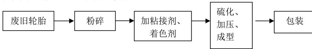
图2-3项目生产工艺流程图
